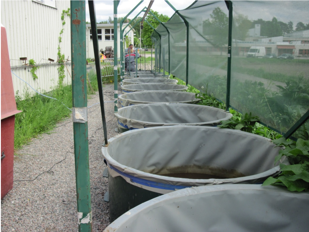
Figur 3. Pilotskalanläggning för mätning av växthusgasemissioner vid JTI, Uppsala.
