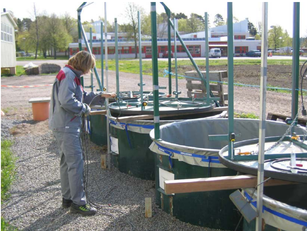
Figur 5. Gasprovtagning förbereds genom utplacering av de tre förslutningarna.
