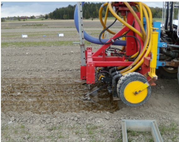
Figur 7. Vårspredning med nedharvning fyra timmar efter spridning. Nedslagning av ramar för gasprovtagning av växthusgaser, med start dagen efter spridning.
