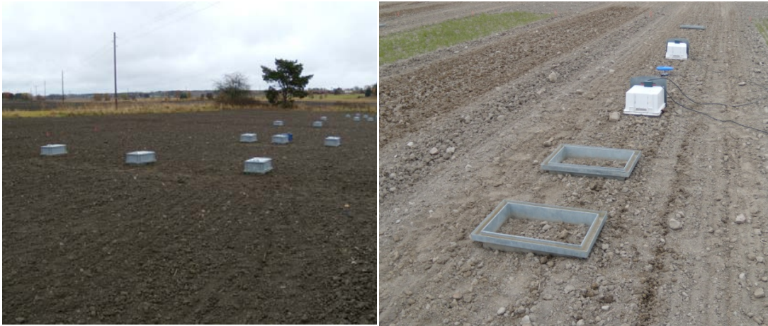
Figur 8. Mätning av växthusgaser med slutna kamrar, tre per småruta på hösten (till vänster). Nedslagna ramar för slutna kamrar efter vårsådd samt pågående mätning av ammoniak efter vårspridning (till höger).
