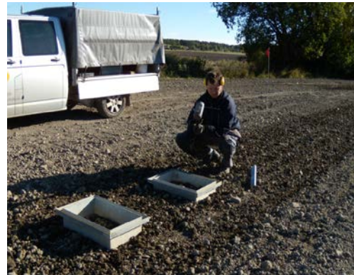
Figur 6. Höstspredning med omedelbar nedharvning följt av sådd. Nedslagning av ramar för gasprovtagning av växthusgaser, med start dagen efter spridning.
