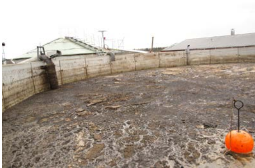
Figur 2. Boj med kedja med temperaturloggrar på två nivåer under ytan i behållare med rötad flytgödsel.
