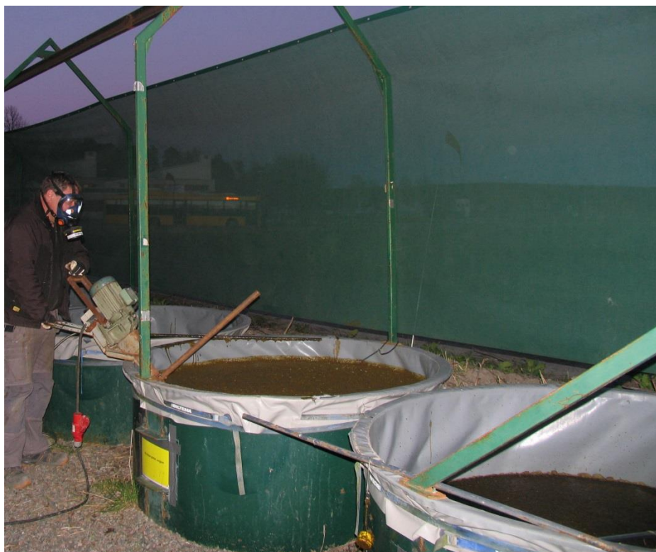
Figur 9. Omrörning av rötad gödsel (led D) efter tillsättning av syra. Nivån i behållaren steg betydligt p.g.a. skumbildning. Ansiktsmask användes p.g.a. gasbildning till följd av syratillsatsen.
